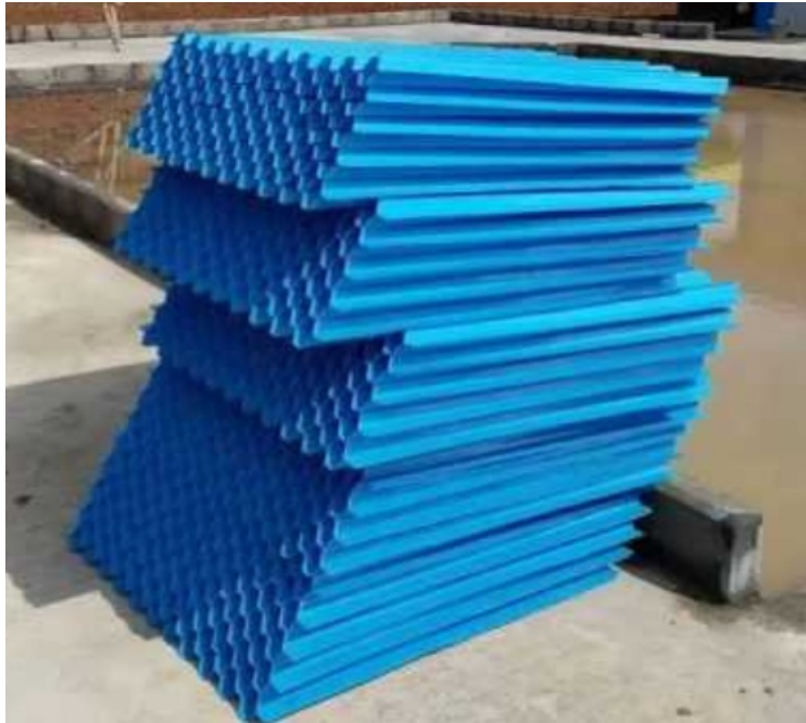
Gambar 4. Media sarang tawon untuk media penumbuh bakteri.
